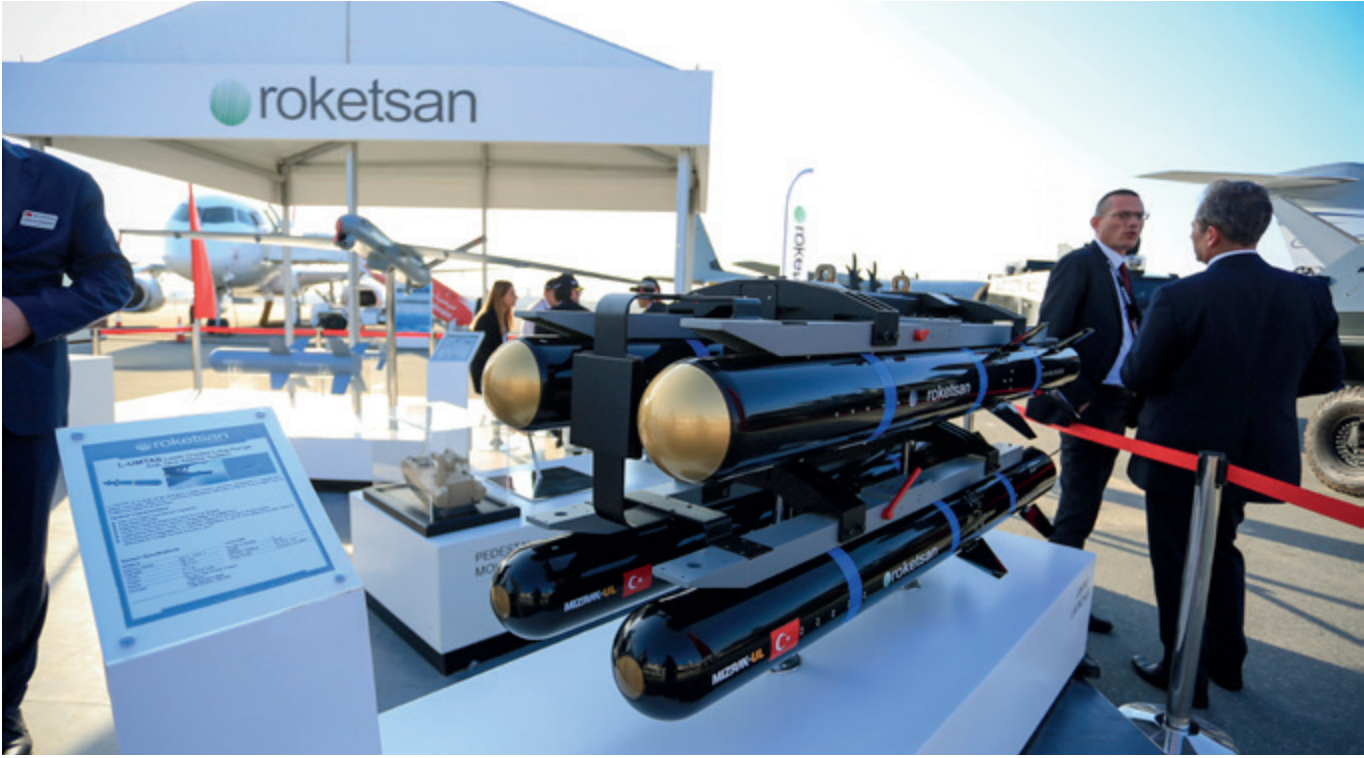
Dörtlü füze fırlatma lançerinin üst bölümünde iki adet Kızılötesi Görüntüleyici Arayıcı (IIR) Başlıklı UMTAS, alt bölümünde iki adet Lazer Arayıcı Başlıklı L-UMTAS füzesi.
